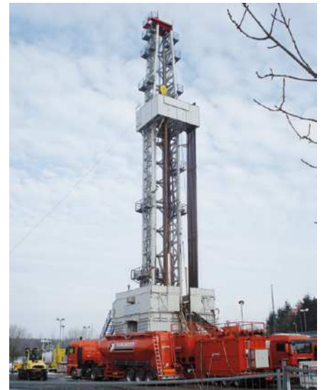
Tanklaster mit Stimulationsfluid und hydraulische Pumpen vor einer Bohranlage
